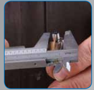
3. ENTSPRECHENDEN FLACHSENKER AUSWÄHLEN
