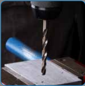
1. BOHRUNG FÜR DEN KEGELSENKER
