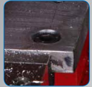
6. NACH DEM VERSENKEN DES SCHRAUBENKOPFS
