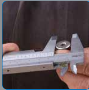
2. SCHRAUBENKOPF VERMESSEN, DER VERSENKT WERDEN SOLL
