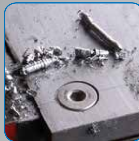
6. NACH DEM VERSENKEN DES SCHRAUBENKOPFS
