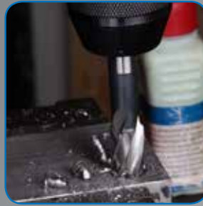
4. DIE FLACHSENKUNG HERSTELLEN
