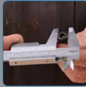
2. SCHRAUBENKOPF VERMESSEN, DER VERSENKT WERDEN SOLL
