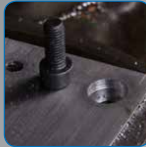
5. DEN SCHRAUBENKOPF IN DIE BOHRUNG VERSENKEN
