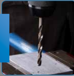
1. BOHRUNG FÜR DEN FLACHSENKER
